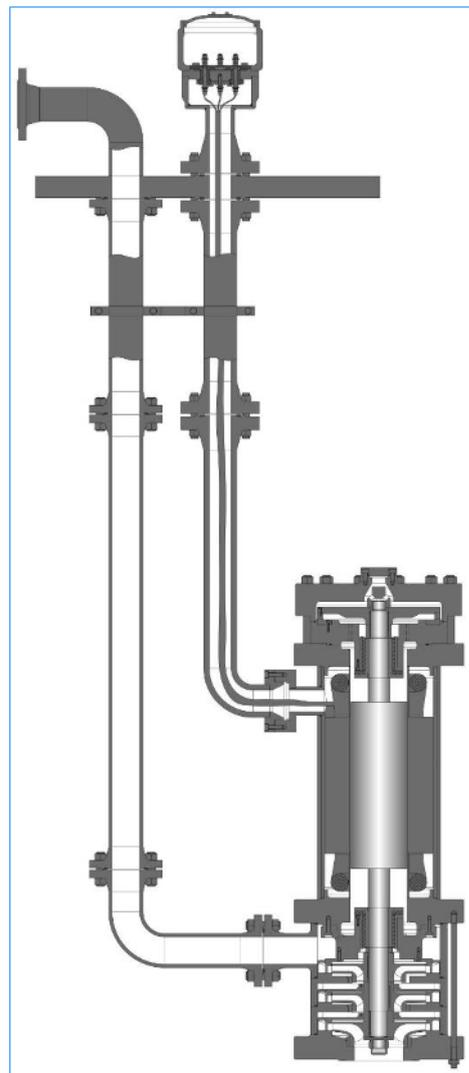
применением специальных распределительных дисков, которые позволяют компенсировать осевые силы при работе агрегата.
