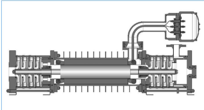
используются там, где есть потребность в перекачивании сред с высокими температурами, но нет возможности подвести жидкость для охлаждения. Перекачиваемая среда может быть в том числе химически активной, агрессивной, токсичной, взрывоопасной, горючей и содержать вредные вещества всех классов опасности, однако одним из условий применения данной конструкции является то, что перекачиваемая жидкость не может менять свое агрегатное состояние (к примеру, затвердевать).
