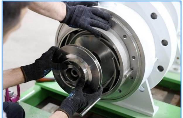
В объем работ входит приёмка насосов в нашей ремонтной базе, разборка и сборка насосов, реинжиниринг конкретных деталей согласно заранее составленному и согласованному с Заказчиком списку, разработка полной конструкторской документации, чертежей и проектирование 3D моделей деталей (в объеме достаточном для возможности изготовления данных деталей) в программах SOLIDWORKS и (или) Компас.
